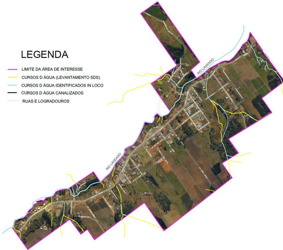
A hidrografia da área de interesse foi conferida *in loco*. Alguns dos pontos checados apresentaram alterações em relação ao levantamento aerofotogramétrico da SDS. Sendo assim, o cartograma original foi adaptada, sendo que em alguns trechos, os afluentes do Rio Lageado foram alterados ou excluídos, por não existirem ou encontrarem-se atualmente canalizados.
